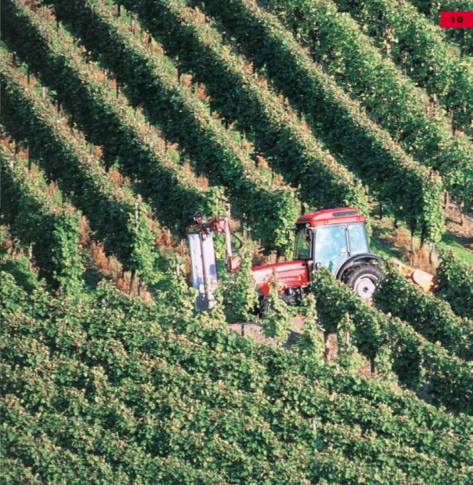
Un centre de gravité bas pour un fonctionnement sûr en pente.
